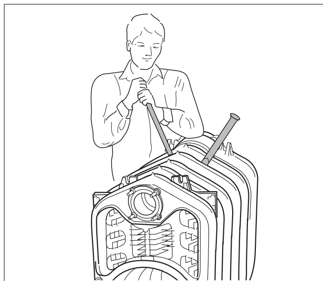
Рис. 27 Разъединение секций котла
