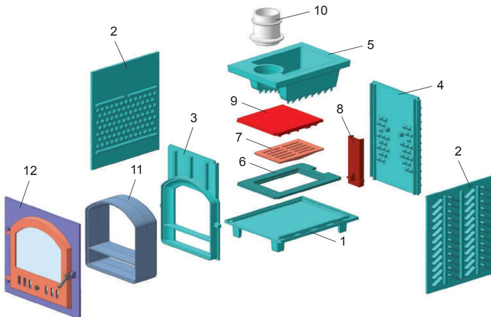
1 – основание; 2 – стенка боковая (2 шт.); 3 – стенка передняя; 4 – стенка задняя; 5 – каменка; 6 – рамка колосниковая; 7 – решетка колосниковая; 8 – воздушник; 9 – пламегаситель; 10 – труба стартовая; 11 – удлинитель портала; 12 – портал с дверцей в сборе.
