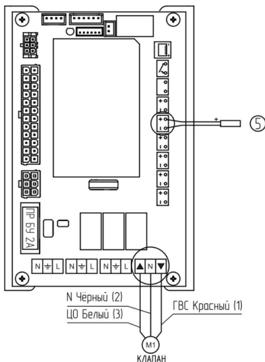
**Рис.3. Схема электрических соединений котла ZOTA MK-S**
