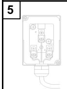
Проведите электрический кабель через кабельный ввод и выполните электрическое соединение, используя зажимы, согласно электрической схеме
