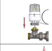
Установка термоголовки с фиксированной температурой на подаче:
