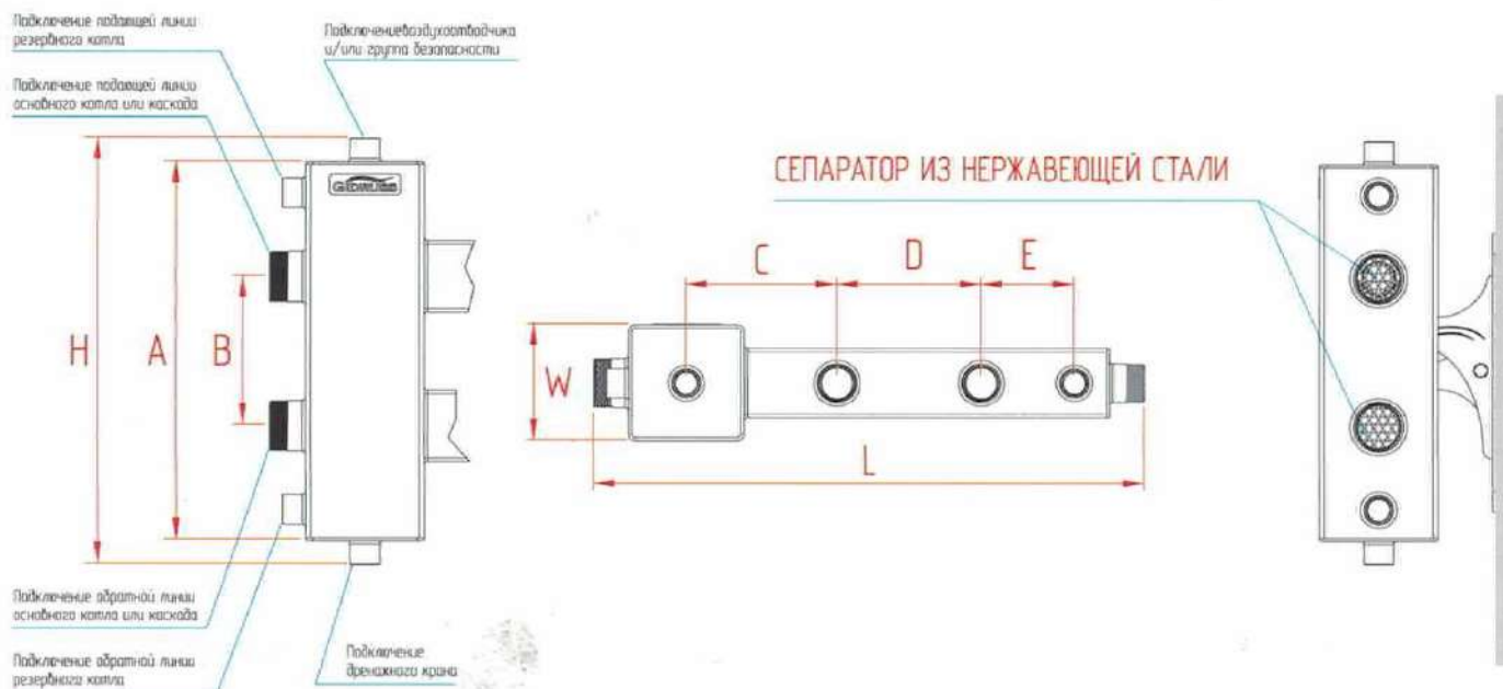
Рис.2. Габаритно-присоединительные размеры общие для всех моделей балансировочных коллекторов
