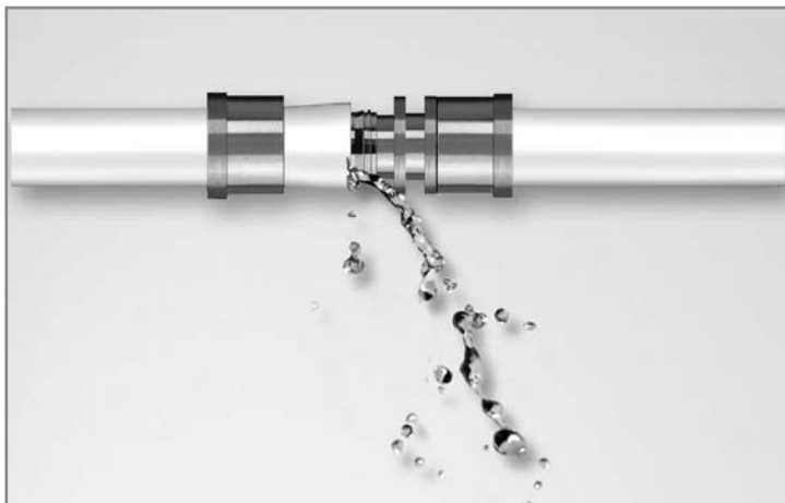
Утечка воды при неопрессованной пресс-втулке
