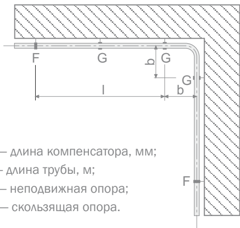
Пример оборудования компенсатора при смене направления трубопровода
