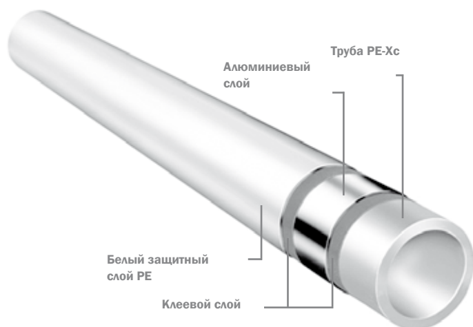
Структура универсальной многослойной трубы TECeFlex
