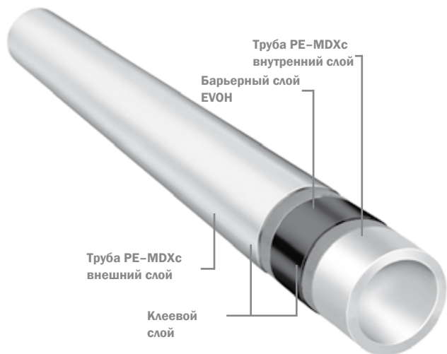
Структура трубы PE-MDXc TECeflex
