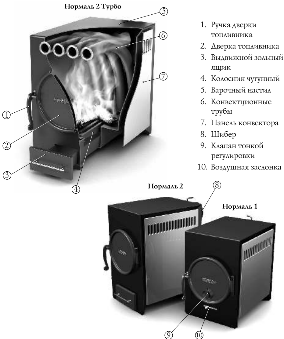
Рисунок 2. Расположение основных элементов печи «Нормаль».
