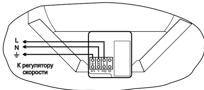
**Рис.2. Схема подключения дымососа к регулятору скорости**
