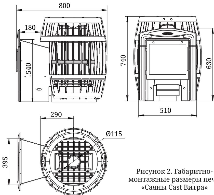
Рисунок 2. Габаритно-монтажные размеры печи «Саяны Cast Витра»
