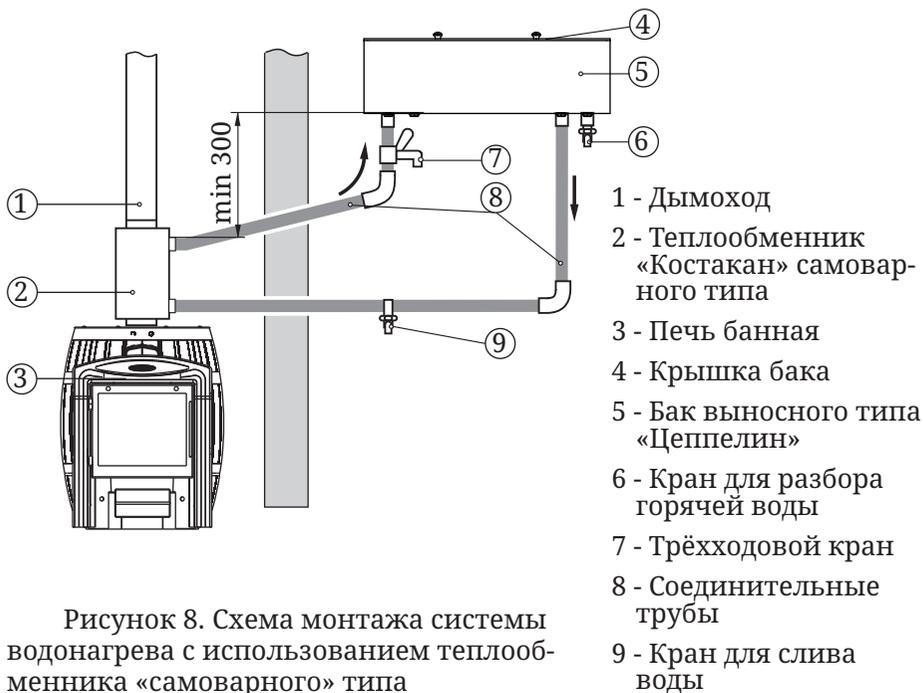
Рисунок 8. Схема монтажа системы водонагрева с использованием теплообменника «самоварного» типа
