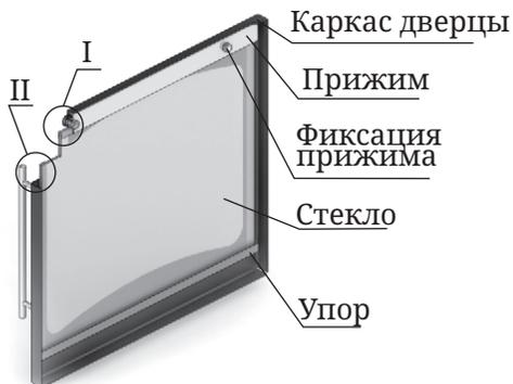
Рисунок 9. Ремонт светорозрачного экрана дверцы модификации «Витра»
