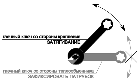
Рис. 5. Подключение к системе подачи теплоносителя
