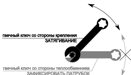
Рис. 5. Подключение к системе подачи теплоносителя
