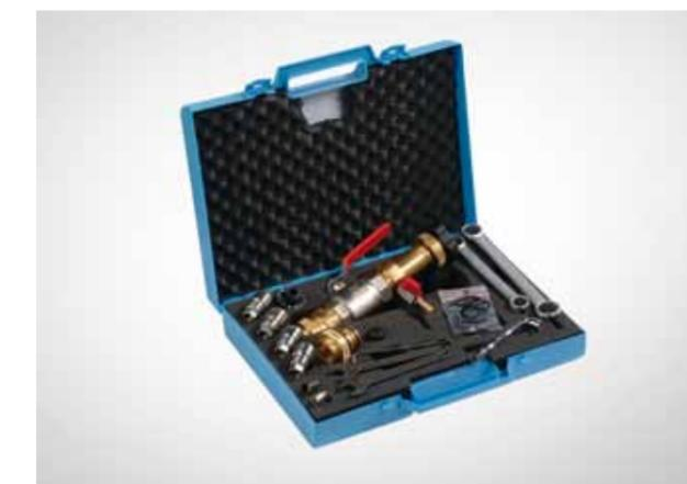
Системы **UniverSAR** и **EuroSAR** можно использовать для преобразования клапана с ручным управлением в термостатический клапан, используя инструмент Demovloc, разработанный Comap, без необходимости демонтажа клапана или слива системы.
