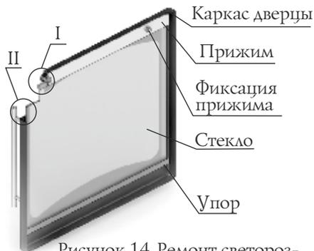
Рисунок 14. Ремонт светорозрачного экрана дверцы модели «Витра»
