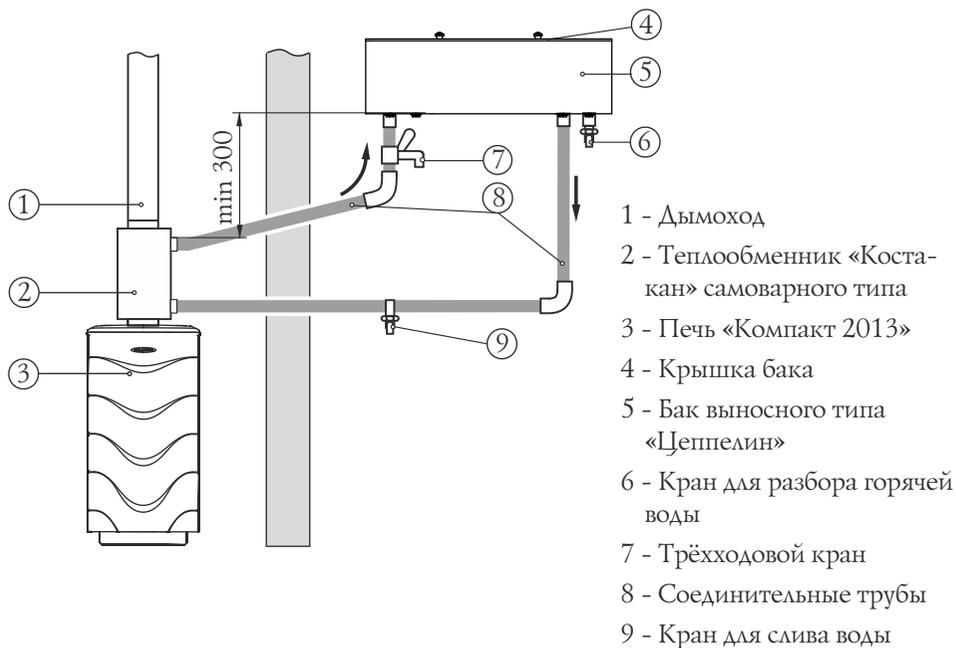
Рисунок 10. Схема монтажа системы водонагрева с использованием теплообменника «самоварного» типа
