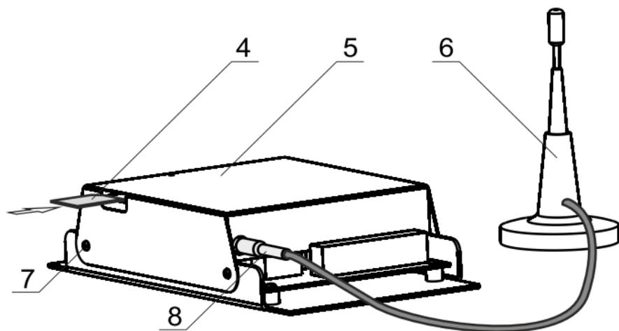
**Рис.2 Подключение модуля GSM к антенне**
