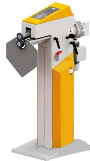
Зиговочная машина RAS с интеллектуальной системой зиг машины "Auto-Teach"
