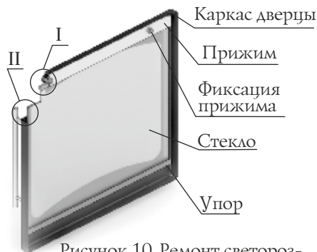
Рисунок 10. Ремонт светорозрачного экрана дверцы модели «Витра»
