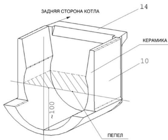
пепла, с помощью кочерги или щетки, необходимо всегда отстранять налет пыли с боковых стенок нижней камеры сгорания. Далее надо открыть крышку для чистки /15/, расположенную в верхней части дымоходного канала и вычистить щеткой задний дымовой канал. Зола-унос
