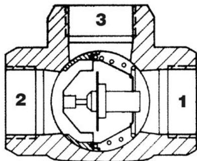
Терморегулирующий вентиль ESBE тип TV 60°C применяется в котлах на твердом топливе. При температуре воды в котле + 60°C открывается терморегулирующий вентиль, и в контур котла (3 →1) впускается жидкость из контура отапливаемого объекта (2). Вводы 1 и 3 открыты постоянно. Таким способом обеспечивается минимальная температура воды, возвратной воды в котел. В случае необходимости можно использовать терморегулирующий вентиль, установленный на более высокую температуру (напр., 72°C).
