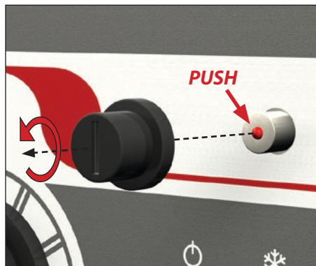
Предохранительный термостат с ручным перезапуском
