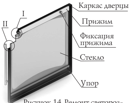
Рисунок 14. Ремонт светопрозрачного экрана дверцы модели «Витра»
