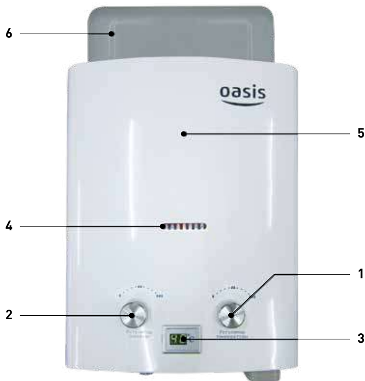
Рис. 1. Аппарат водонагревательный проточный газовый бытовой «OASIS» 1 - ручка водяного регулятора; 2 - ручка газового регулятора; 3 - цифровой индикатор температуры горячей воды; 4 - окно смотровое; 5 - облицовка; 6 - отражатель.
