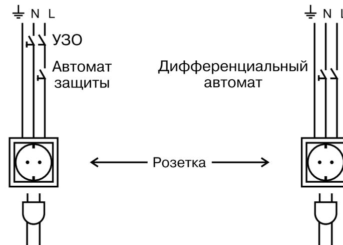
Рис.7 Схема подключения насосной станции к электрической сети
