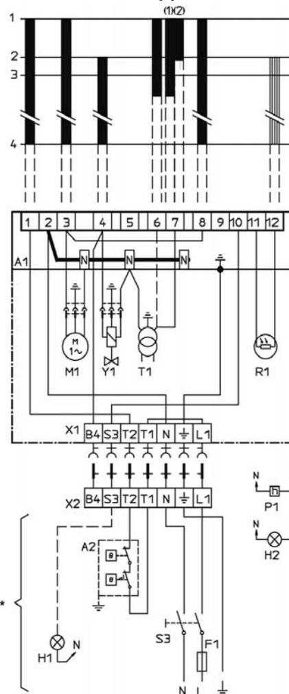
\* Если на котле нет разъема (X2), присоедините к существующему разъему. В случае последовательного подсоединения сдвоенного термостата к клемме L1, необходимо установить перемычку между клеммами T1 и T2.
