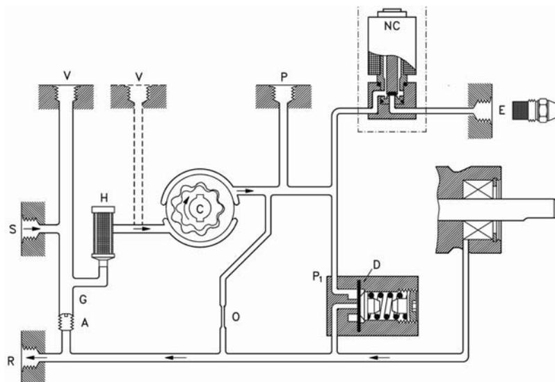
зовали топлива больше, чем может подать шестеренка в данных условиях, давление топлива падает ниже установленной величины и регулятор закрывается по ходу обратки (R) посредством диафрагмы (D) и переходит в стартовую позицию.
