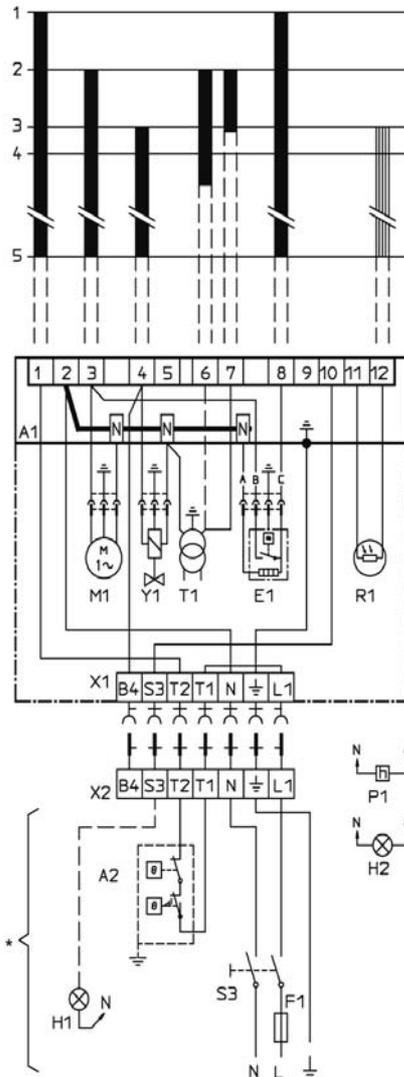
\* Если на котле нет разъема (X2), присоедините к существующему разъему. В случае последовательного подсоединения сдвоенного термостата к клемме L1, необходимо установить перемычку между клеммами T1 и T2.
