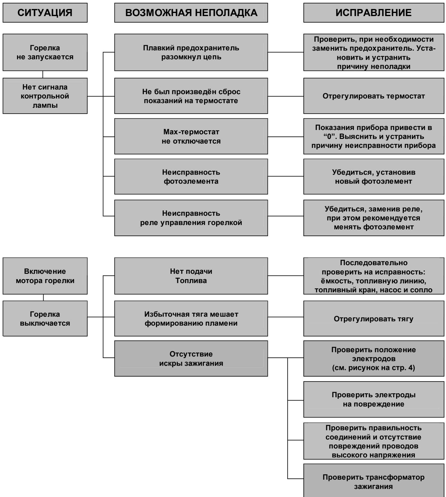
**БЛОКИРОВКА ГОРЕЛКИ ПОСЛЕ ПРОИЗВЕДЁННОГО ЗАПУСКА**
