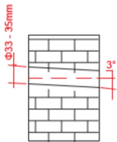
1. Просверлите в стене под трубку Ø22 мм (для комфорного монтажа это будет ~Ø33-35 мм). Чтобы исключить риск замерзания, отверстие должно быть просверлено под углом примерно 3° вниз по направлению к внешней стороне здания.
