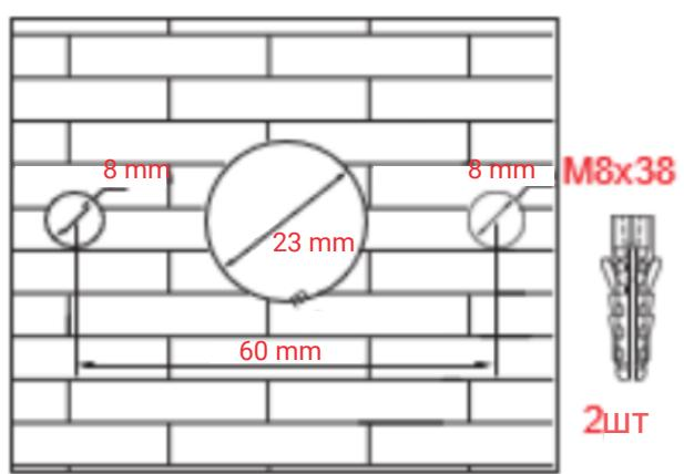
3. Просверлите в стене 2 монтажных отверстия диаметром 8 мм на расстоянии 60 мм. Установите пластиковые дюбели в отверстия.
