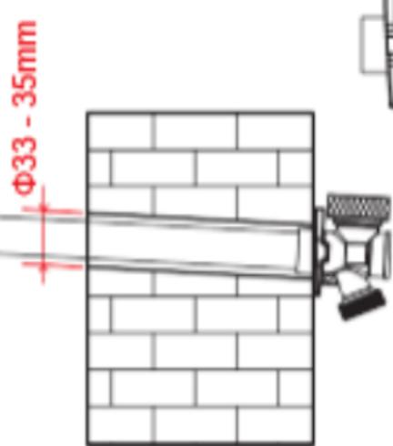
2. Смонтируйте трубку (3) в ранее сделанное отверстие в стене. Излив с утолщенной площадкой позволяет сразу расположить кран с правильным уклоном 3°. Это поможет воде самой вытекать из трубы после закрытия крана.
