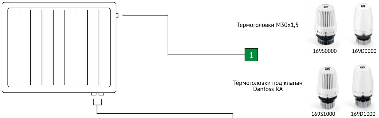
**Подключение панельного радиатора с наружной резьбой 3/4"ЕК**
