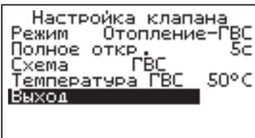
Температура в контуре ГВС определяется уставкой «Температура ГВС» которая может быть выставлена на 20-75°C. При этом точность поддержания температуры в контуре ГВС будет определяться режимом регулирования (грубый -точный) с его настройками.
