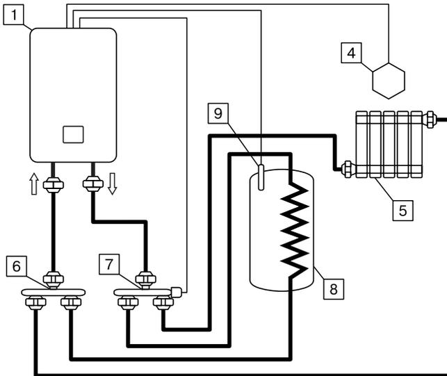
**Рис.6 Упрощённая схема подключения котла в режиме «Отопление-ГВС».**
