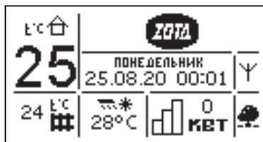
8.19.1.2. Проверьте уровень сигнала сети GSM в пункте меню «GSM/LAN-модуль → Уровень сигнала». Для надежной связи уровень должен быть в пределах 3-5 единиц. Если уровень меньше 3 единиц то предпримите меры для улучшения качества сигнала, например переносом GSM-антенны в другое место. Если вместо уровня отображается прочерк «-», то значит связь отсутствует и вам следует обратиться в сервисную службу компании ZOTA по телефону (391) 219-11-41.
