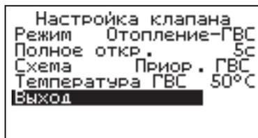
«Насос2» блокируется. Идет нагрев только контура ГВС.
