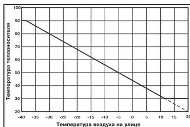
Для примера приведен график регулирования температуры теплоносителя, температура теплоносителя установлена +30°C («Темп. воды 1») при температуре на улице +11°C («Темп. улицы 1») и температура теплоносителя установлена +90°C («Темп. воды 2») при температуре на улице -38°C («Темп. улицы 2»).
