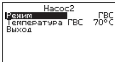
В режиме ОТОПЛЕНИЕ могут использоваться датчики температуры воды «tдатч3» и воздуха «tдатч4». Для корректной работы системы в режиме ГВС необходимо выбрать в меню котла «Насос1» режим «Авто». В этом режиме насос1 будет останавливаться, если температура в помещении достигла уставки, но при этом требуется, нагрев контура ГВС.
