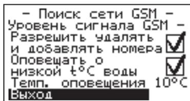
8.19.1.3. Установите галочку в пункте меню «GSM/LAN-модуль → Разрешить удалять и добавлять номера».
