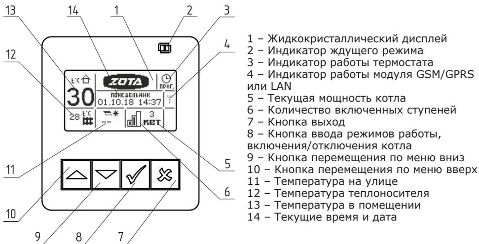
**Рис.2 Расположение органов управления и индикации на передней панели.**
