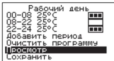
При нажатии кнопки «ВВОД» на текущем периоде откроется экран настройки этого периода, где можно изменить время, температуру воздуха и теплоносителя для данного периода времени, максимальную мощность, либо удалить период из списка.
