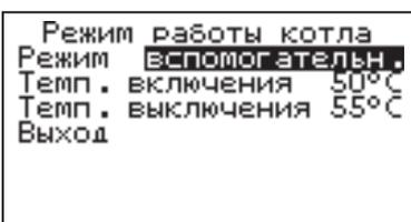
При достижении основным котлом температуры выключения нагрев отключается. Температура основного котла контролируется датчиком «tдатч2» который должен быть установлен как можно ближе к патрубку подачи основного котла. В контуре вспомогательного котла в этом режиме используется насос1 в режиме «Авто», который отключается через 30 сек после отключения нагрева вспомогательного котла.
