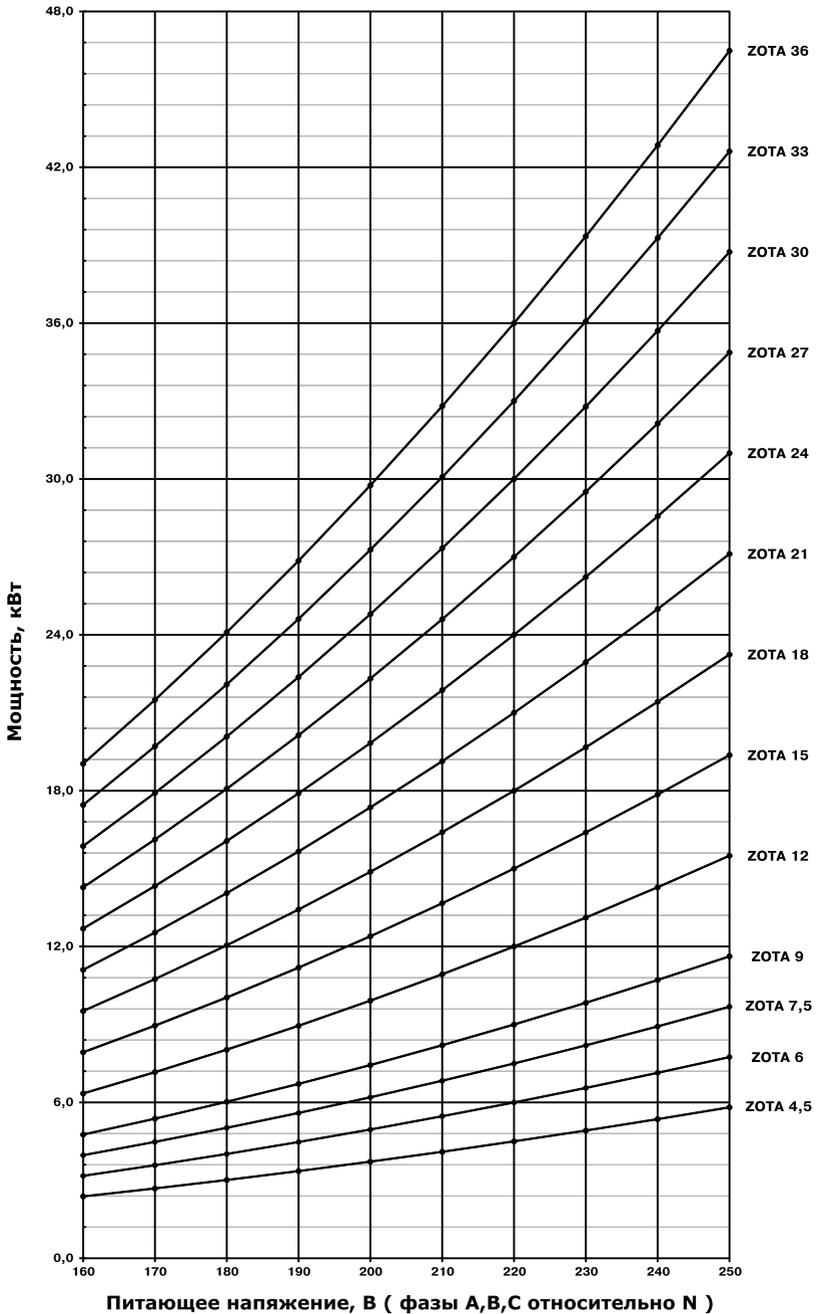
Рис.8 График изменения мощности котла в зависимости от питающего напряжения.
