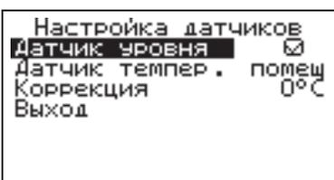
Можно скорректировать показания датчика воздуха в помещении «tдатч1», датчика воздуха «tдатч4» и датчика улицы «tдатч2» для обеспечения более точных показаний в различных условиях эксплуатации.
