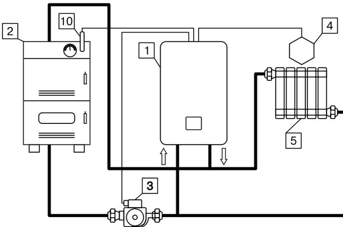
**Рис.7 Упрощенная схема подключения котла в режиме вспомогательной.**
