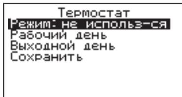
Настройте суточный или недельный цикл температуры воздуха в помещении или теплоносителя. Эти функции необходимы, если требуется поддерживать разную температуру днем и ночью, разную температуру по дням недели (например, если требуется отапливать помещение только по выходным дням).
