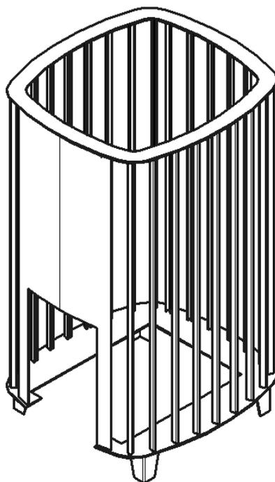
Рис. 3 Устройство декоративно-защитного ограждения печи Сударушка Руса Семейная
