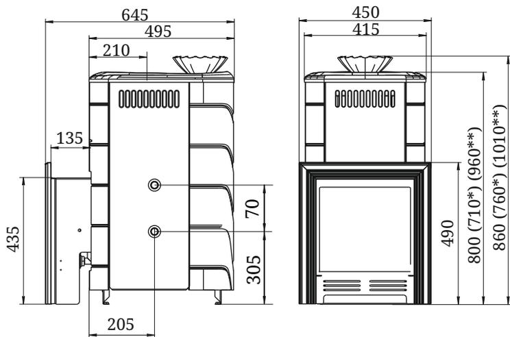
**Рисунок 1. Габаритно-монтажные размеры печи «Таймыр 2017»**
