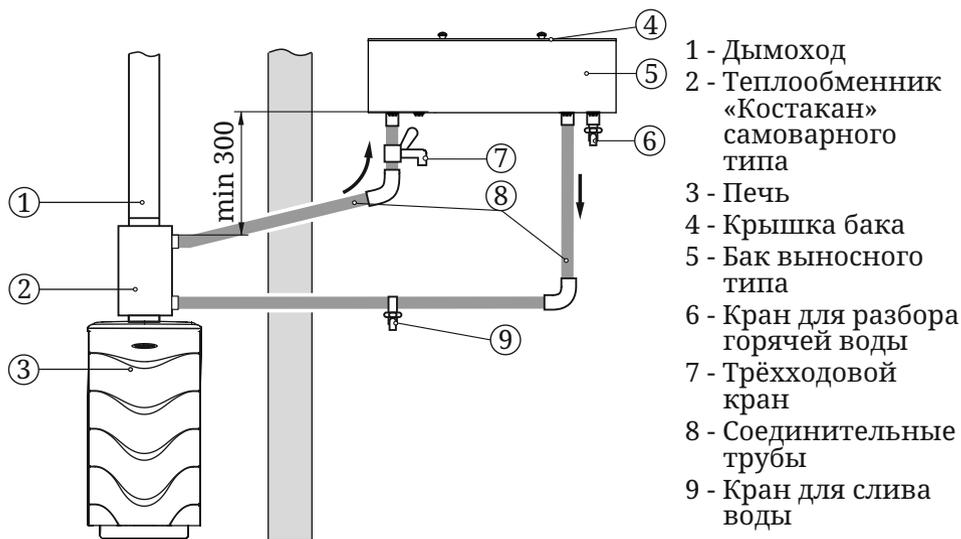
Рисунок 11. Схема монтажа системы водонагрева с использованием теплообменника «самоварного» типа
