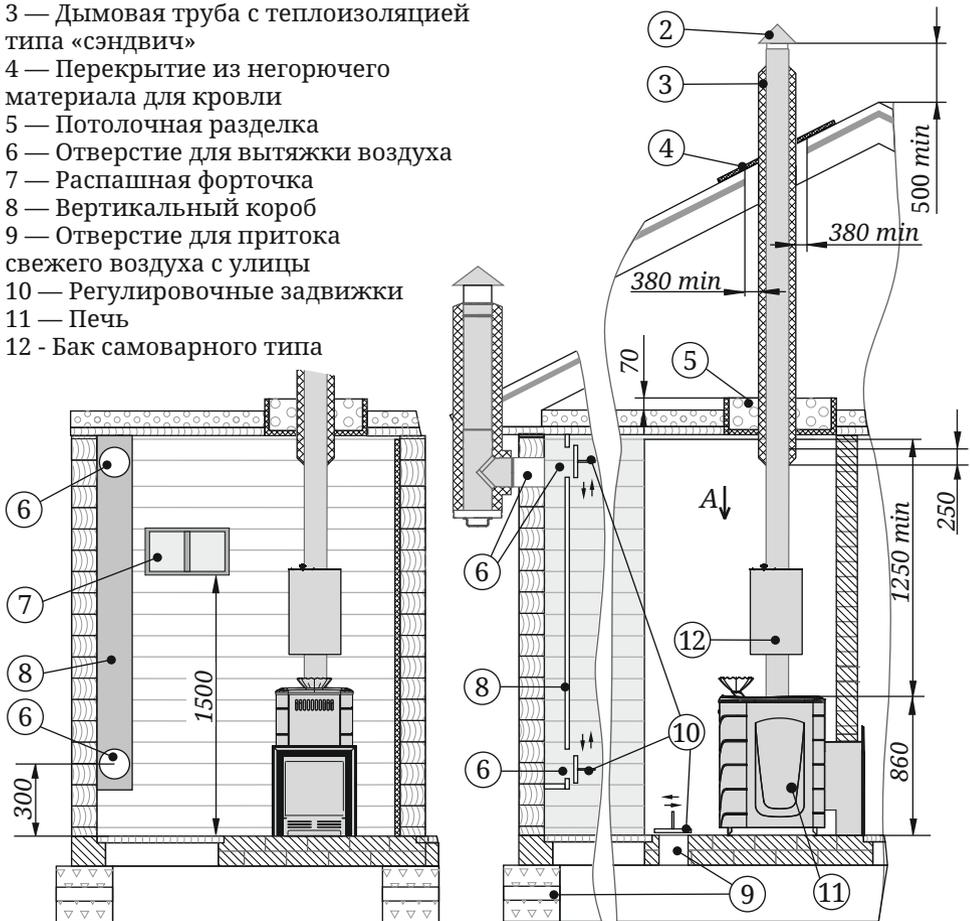
**Рисунок 3. Схема монтажа печи в помещении с перегородкой из негорючего материала**
