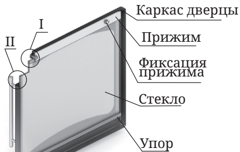
Рисунок 10. Ремонт светопрозрачного экрана дверцы модификации «Витра»
