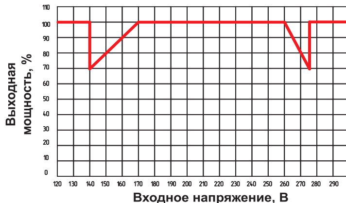
Рис.4 Максимальная мощность нагрузки в зависимости от напряжения сети.
