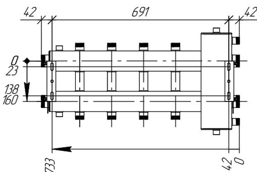
Регулируемый вылет оси трубопроводов от стены
